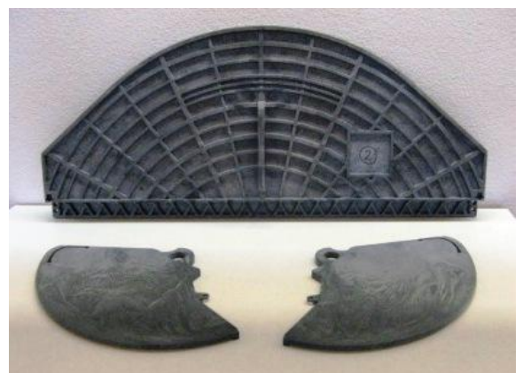
Tragende Teile eines Gepäckabfertigungssystems, ursprünglich aus Holz, jetzt mit TSG gefertigt.
